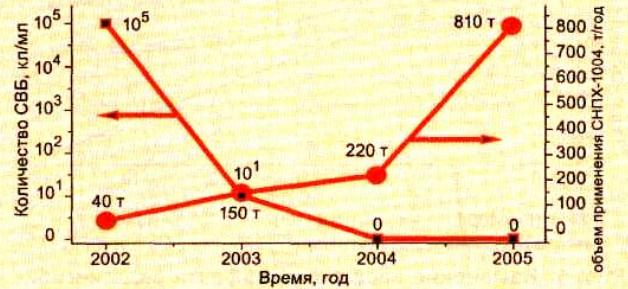
Рис. 5. Снижение количества СВБ на одном из месторождений ОАО «Удмуртнефть» при применении СНПХ-1004
