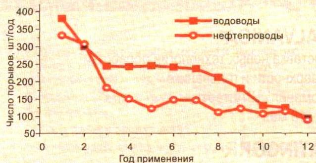
Рис. 2. Отказы трубопроводов по причине внутренней коррозии в ОАО «АНК «Башнефть» на фоне применения СНПХ-1004
