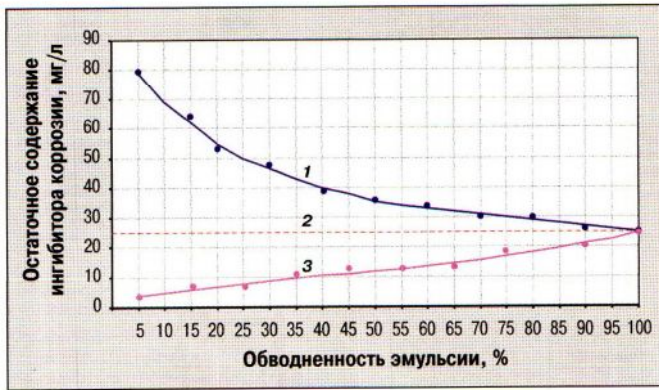
Рис. 1. Зависимость содержания перешедшего в водную фазу водорастворимого и углеводородорастворимого ингибиторов от обводненности эмульсии: 1, 3 – соответственно водорастворимый ингибитор СНПХ-1004Р и углеводородистый ингибитор коррозии; 2 – дозировка реагента из расчета 25 мг/л жидкости
