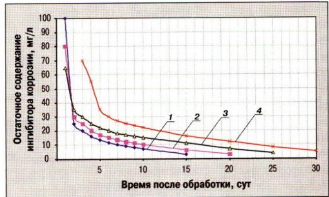
Рис. 2. График выноса СНПХ-1004Р при использовании его по технологии заливки в межтрубное пространство: 1, 2, 3, 4 – дебит скважин составляет соответственно более 90, 50-90, 20-50 и менее 20 м 3 /сут
